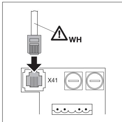
Рис. 4–19: Подключение преобразователя частоты двигателя к X41, цвет кабеля - белый
