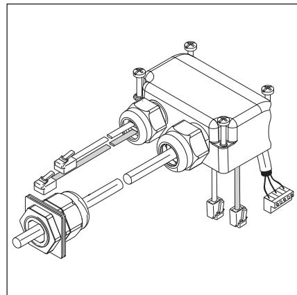
Рис. 4-4: Подготовленная крышка розетки для подсоединения электродвигателя
