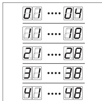
Рис. 8-12: Индикация номеров неисправностей от 01...04 до 41...48
