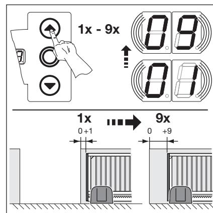
Рис. 6-22: Регулировка конечного открытого положения ворот дальше в направлении открытия ворот
