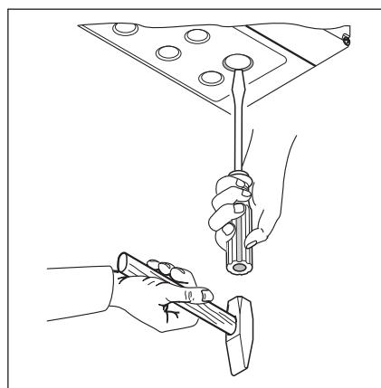
Рис. 7-2: Для дооснащения кабельной арматурой с резьбовым соединением выбирайте предварительно выдавленные места гнезд только при **закрытой** крышке
