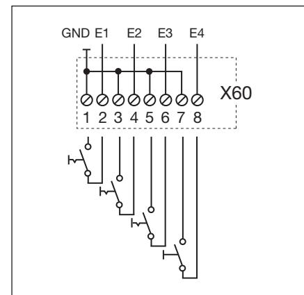
Рис. 7-14: Подключение входов E1 - E4
