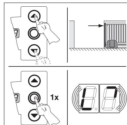
Рис. 6-16: Программирование конечного открытого положения ворот
