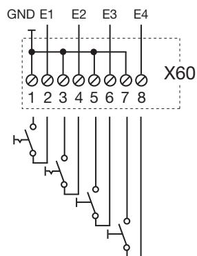
Рис. 7-10: Подключение входов E1 - E4
