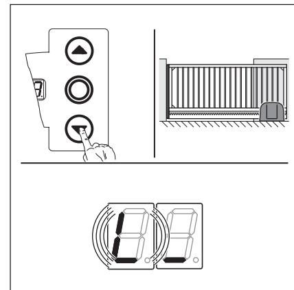
Рис. 6–21: Контроль конечного закрытого положения ворот
