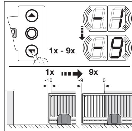
Рис. 6-23: Регулировка конечного открытого положения ворот дальше в направлении закрытия ворот
