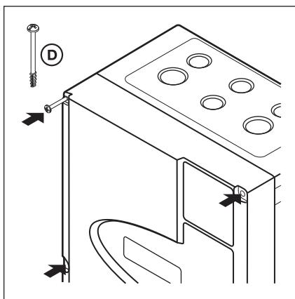
Рис. 3–14: Закрутите все винты крепления крышки (6x)
