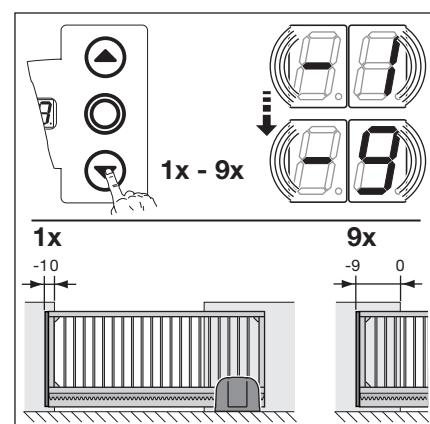
Рис. 6–25: Регулировка конечного закрытого положения ворот дальше в направлении закрытия ворот
