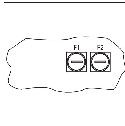
Рис. 8-19: Предохранители F1 и F2
