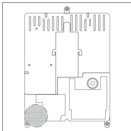
Рис. 4–15: Положение выводов для подключения двигателя X91 на плате управления
