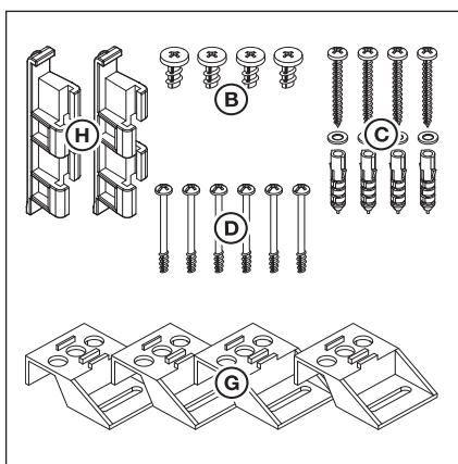
Рис. 3–15: Содержимое пакета с принадлежностями для дополнительного корпуса
