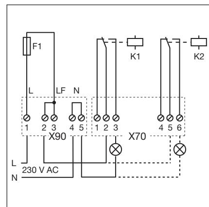
Рис. 7-17: Электрическая схема реле и пример подключения для лампы 230 В
