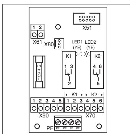
Рис. 6–37: Многофункциональная плата с реле K1 и K2
