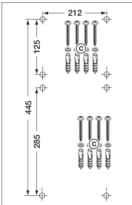
Рис. 3–19: Схема расположения отверстий для крепления, необходимые детали для монтажа
