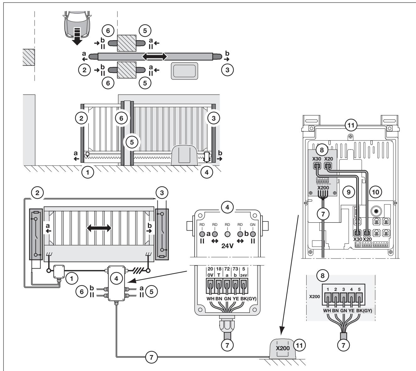
Рис. 7-22: Предохранитель замыкающего контура
