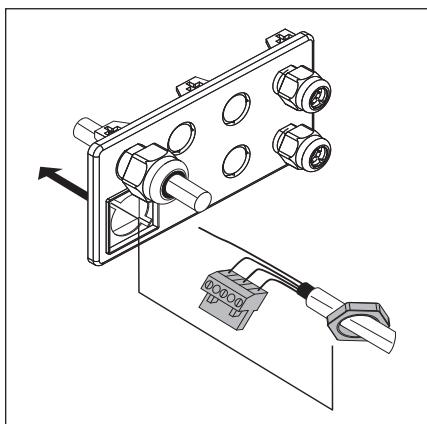
Рис. 4-9: Продевание вилки и гайки крепления через фланцевую пластину
