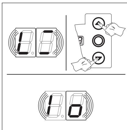
Рис. 6-13: Удалить имеющиеся значения. На дисплее отображается вид монтажа Внутри справа I.
