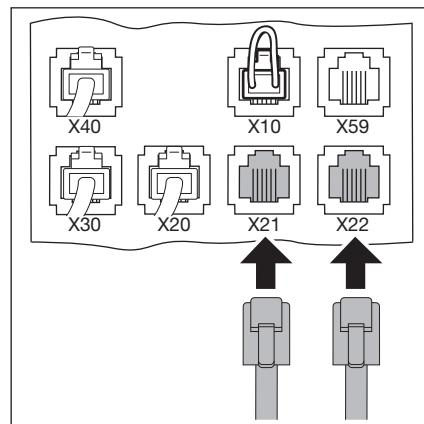
Рис. 4–22: Подключение устройств безопасности с помощью системного провода
