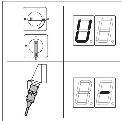
Рис. 6–5: Включить напряжение, индикация «не обучены» или «промежуточное конечное положение»
