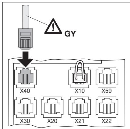
Рис. 4–18: Подключение датчика положения ворот электродвигателя к X40, цвет кабеля - серый
