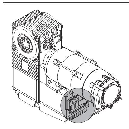
Рис. 4-5: Положение платы для подсоединения двигателя на электродвигателе
