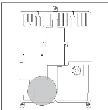
Рис. 4–28: Положение вывода для подключения к сети X90 внутри корпуса блока управления
