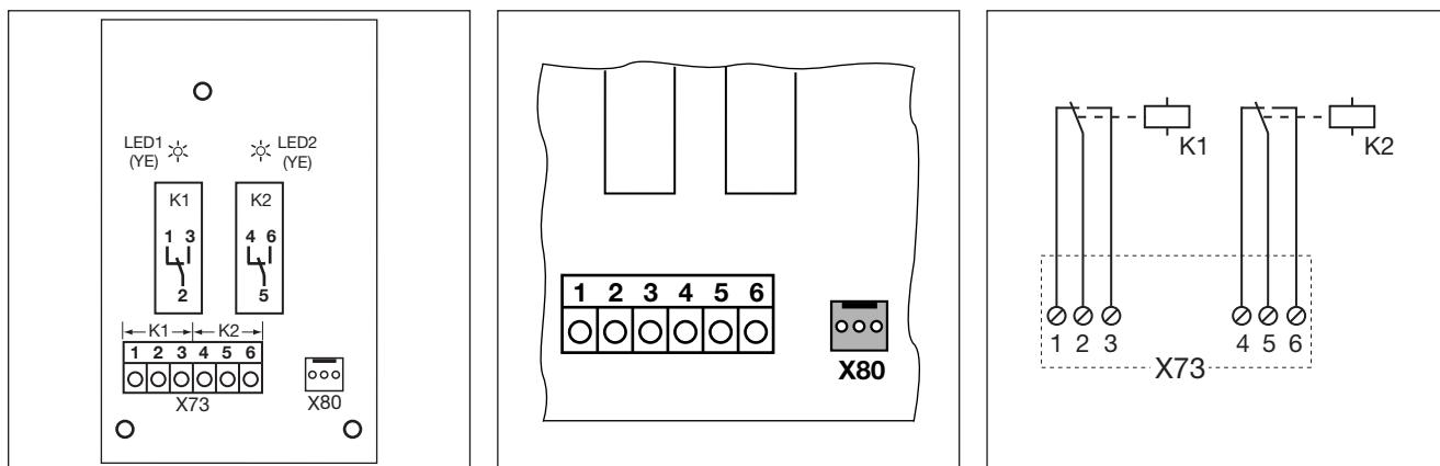
Рис. 7-19: Схема расположения компонентов платы
