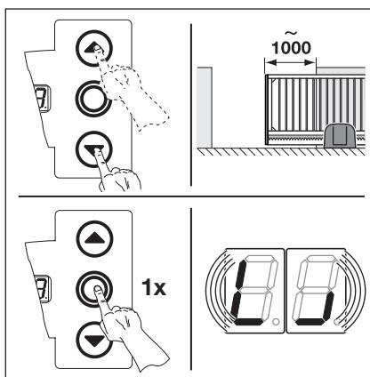
Рис. 6-17: Программирование точки торможения при открытии ворот
