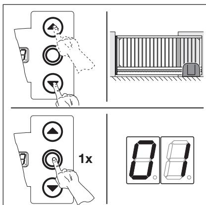
Рис. 6-19: Программирование конечного закрытого положения ворот
