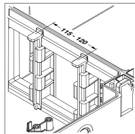
Рис. 3–17: Проверьте правильное положение соединительных деталей корпуса
