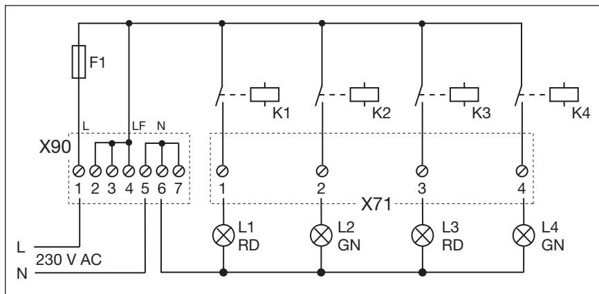
Рис. 7-8: Электрическая схема электропитания и реле
