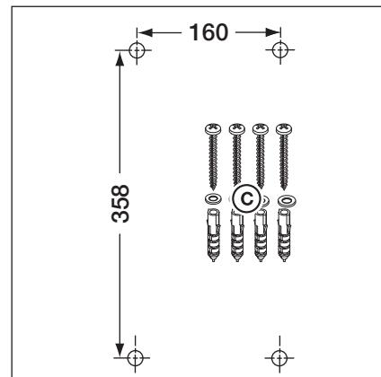
Рис. 3-7: Схема расположения отверстий для крепления, необходимые детали для монтажа
