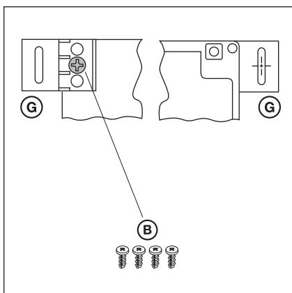
Рис. 3-9: Крепление монтажных опор, вид сзади и спереди
