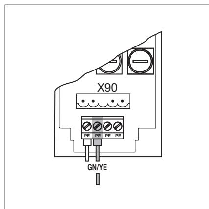
Рис. 4–29: Подсоединение защитного провода кабеля для подключения к сети
