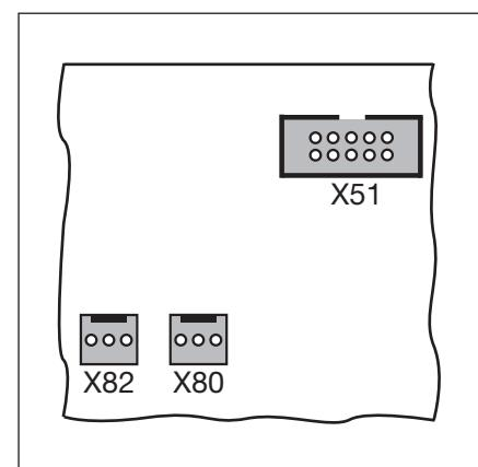
Рис. 7-13: X51 = гнездо для подключения к блоку управления, X80/82 = гнездо для подключения дополнительных плат
