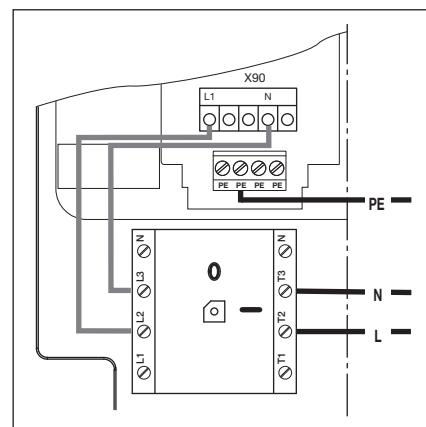
Рис. 4–26: Подключение однофазной сети к главному выключателю
