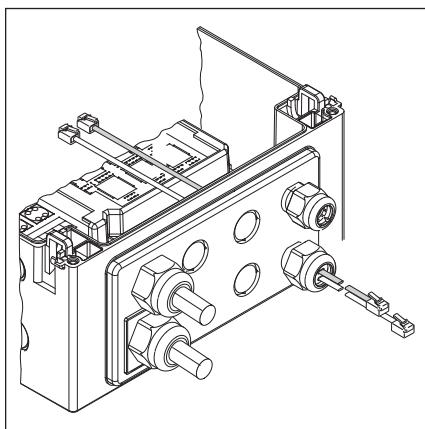
Рис. 4–14: Окончательно смонтированная крепежная фланцевая пластина
