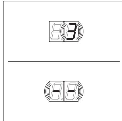
Рис. 8-16: Индикация, напр. 3 = номер функции 3; напр. -- = никакая функция не запограммирована
