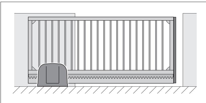
Рис. 6–3: Монтаж внутри слева
