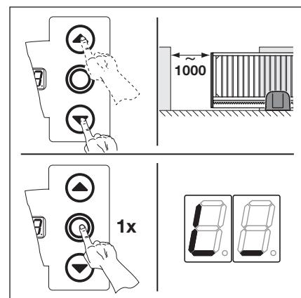
Рис. 6-18: Программирование точки торможения при закрытии ворот
