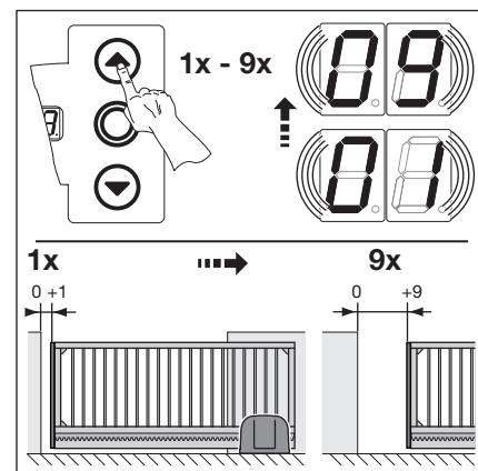
Рис. 6–24: Регулировка конечного закрытого положения ворот назад в направлении открытия ворот
