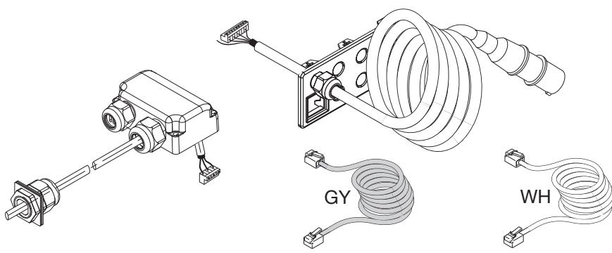
Рис. 4-1: Для монтажа необходимы: винты из пакета со вспомогательными принадлежностями, провод для подключения электродвигателя, провод для подключения к сети, 6-жильный системный провод.
