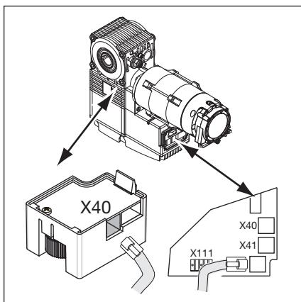
Рис. 9–1: Расположение платы подсоединения электродвигателя
