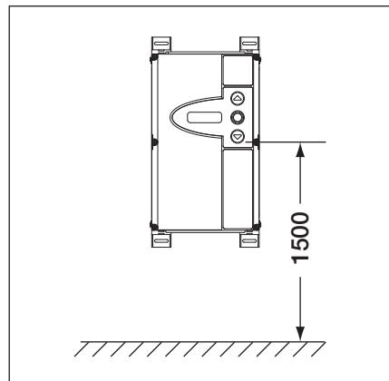
Рис. 3-2: Высота монтажа
