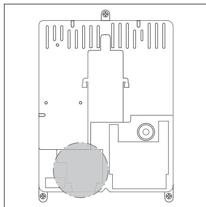
Рис. 8-18: Расположение предохранителей F1 и F2
