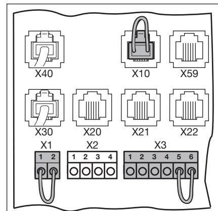
Рис. 4-31: Вставные перемычки X1/X3, перемыкающая вилка X10
