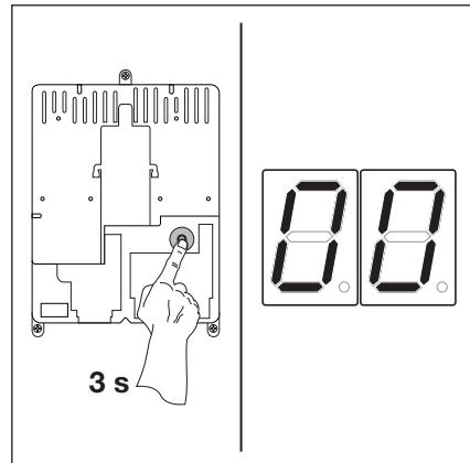
Рис. 6–6: Начать программирование
