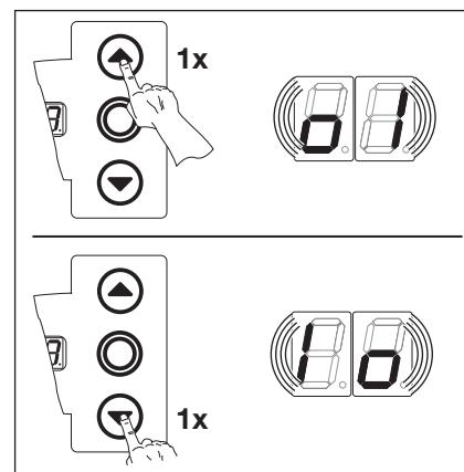
Рис. 6-14: Выберите вид монтажа «Внутри слева» или «Внутри справа»
