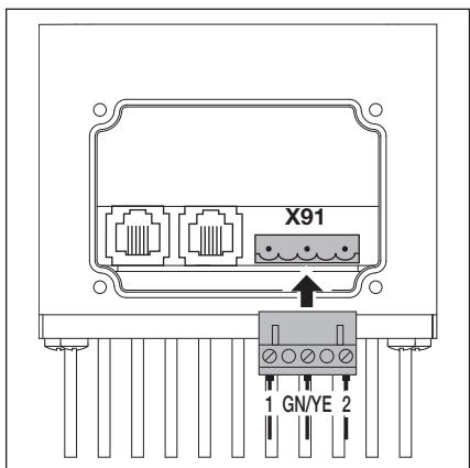
Рис. 4-6: Подсоединение провода электродвигателя к присоединительной плате двигателя
