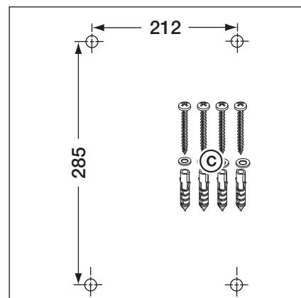
Рис. 3-10: Схема расположения отверстий для крепления, необходимые детали для монтажа
