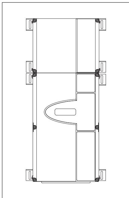
Рис. 3–18: Корпус блока управления и дополнительный корпус с горизонтально закрепленными монтажными опорами
