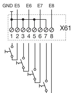
Рис. 7-11: Подключение входов E5 - E8
