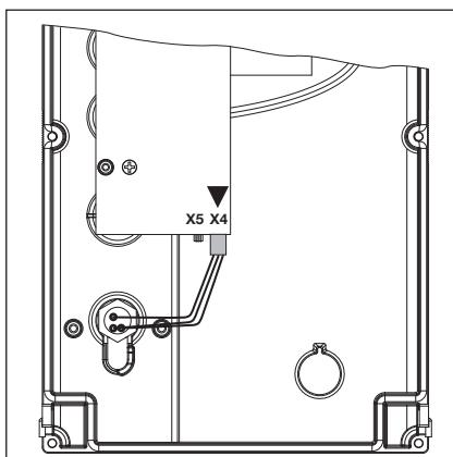
Рис. 6–35: Подключение миниатюрного замка, внутренняя сторона крышки, переставить с X5 в X4
