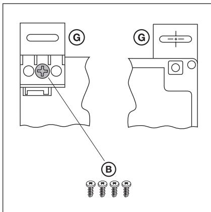
Рис. 3-6: Крепление монтажных опор, вид сзади и спереди
