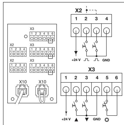
Рис. 4–21: Подключение дополнительных внешних элементов управления к X10
