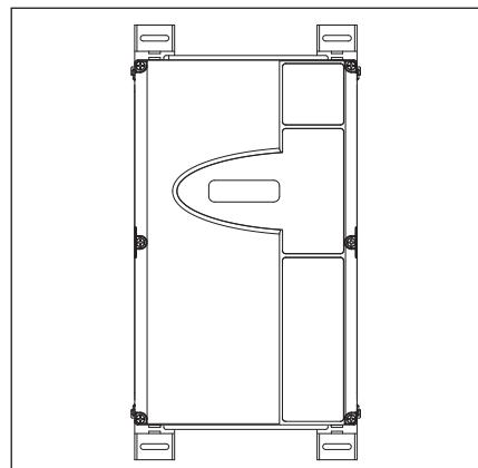
Рис. 3-5: Корпус блока управления с вертикально закрепленными монтажными опорами
