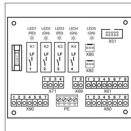
Рис. 7-5: Схема расположения компонентов платы
