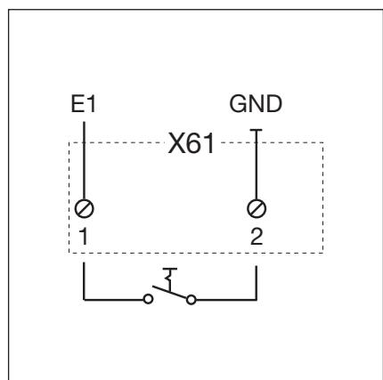
Рис. 7-18: Подключение входа E1
