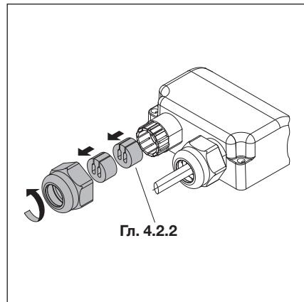
Рис. 4-2: Подготовьте резьбовое соединение для системного провода
