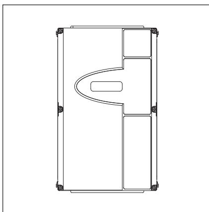
Рис. 3–11: Корпус блока управления без монтажных опор, монтаж непосредственно на стене
