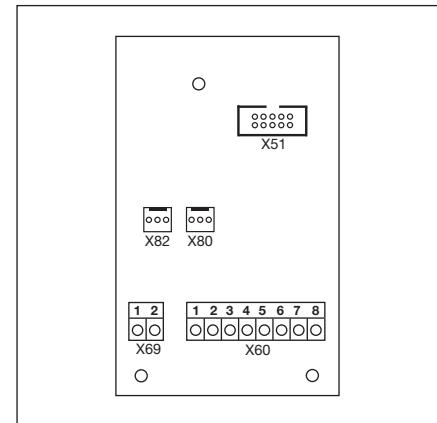
Рис. 7-12: Схема расположения компонентов платы
