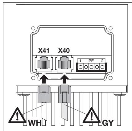
Рис. 4-7: Подключение системного провода к плате подсоединения двигателя. Обратите внимание на цвета проводов!
