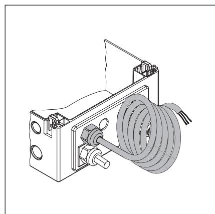
Рис. 4–27: Фланец корпуса с проводом для подключения к сети
