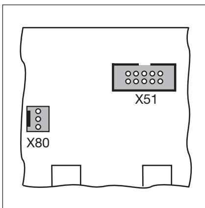
Рис. 7-16: X51 = гнездо для подключения к блоку управления, X80 = гнездо для подключения дополнительных плат
