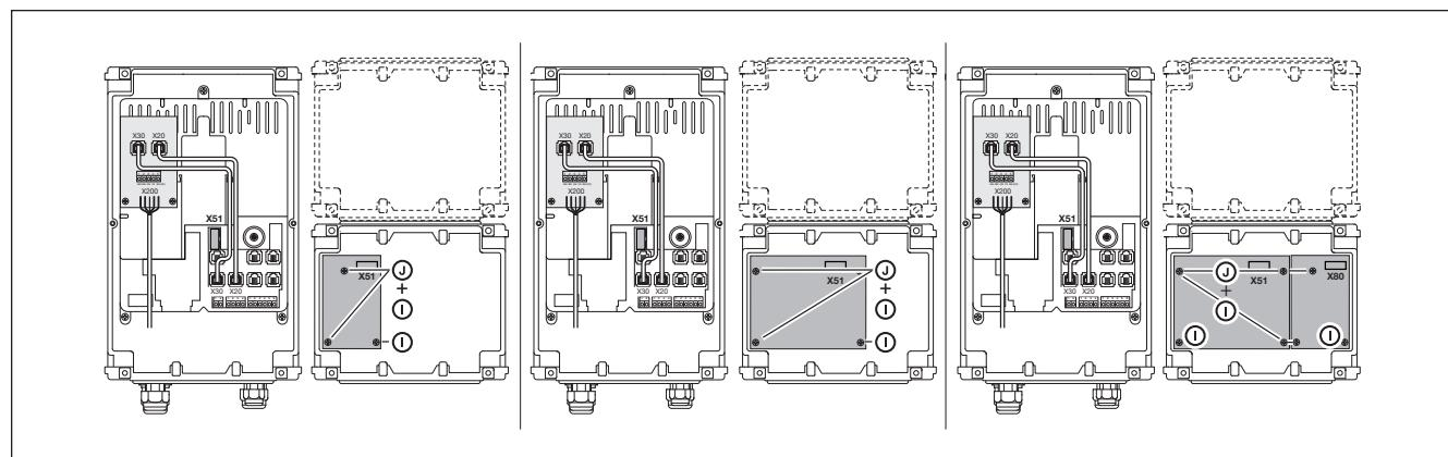
Рис. 7-4: Дополнительный корпус с платой для принадлежностей
