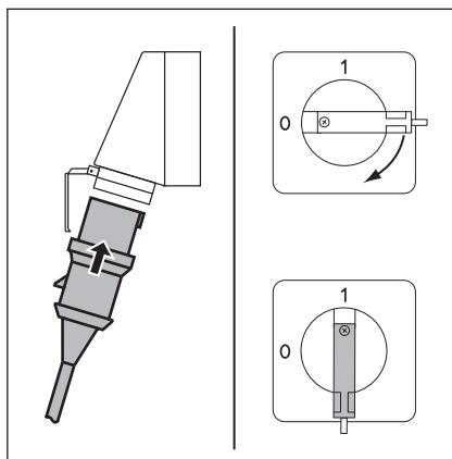
Рис. 8-3: Осуществить подачу напряжения. Установить главный выключатель (опция) в положение 1.
