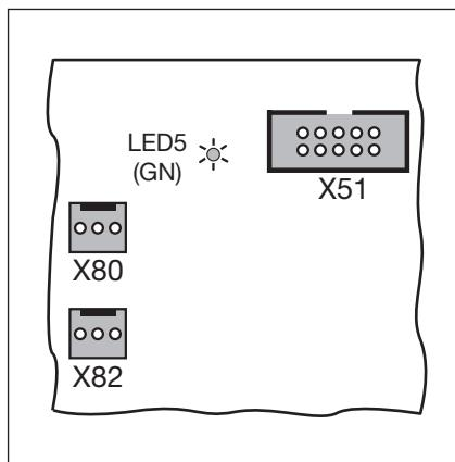
Рис. 7-6: X51 = гнездо для подключения к блоку управления, LED5 = Светодиод рабочего напряжения, X80/X82 = гнездо для подключения дополнительных плат
