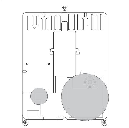
Рис. 4–17: Положение выводов для подключения системного провода X10 – X59 на плате управления
