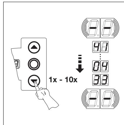
Рис. 8-11: Вызов последних 10 неисправностей. Номера неисправностей, напр. 01, 04, 03
