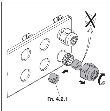
Рис. 4–11: Подготовьте резьбовое соединение для системного провода
