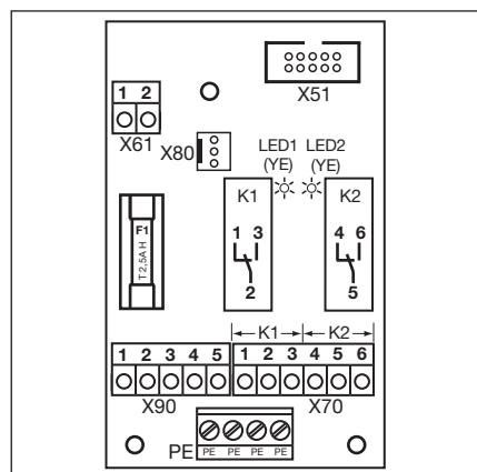
Рис. 7-15: Схема расположения компонентов платы
