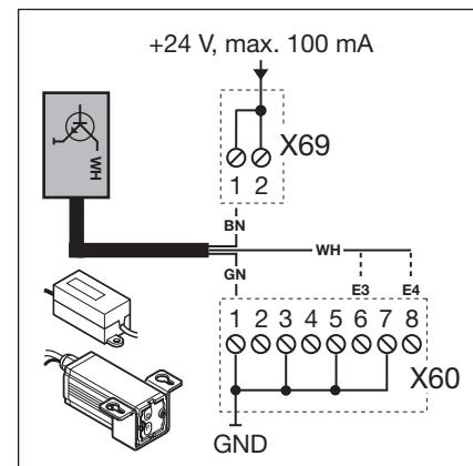
Рис. 7-7: Подключение радиоприемника для команд въезд/выезд
