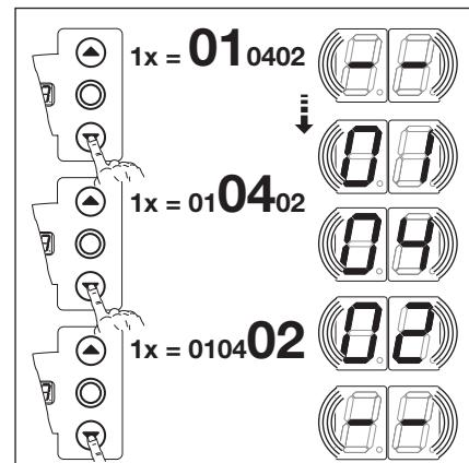
Рис. 8-17: Вызов версии программного обеспечения и исполнения блока управления
