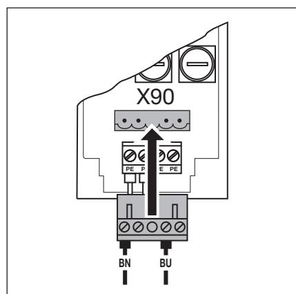
Рис. 4–30: Подключение к сети однофазного переменного тока на X90
