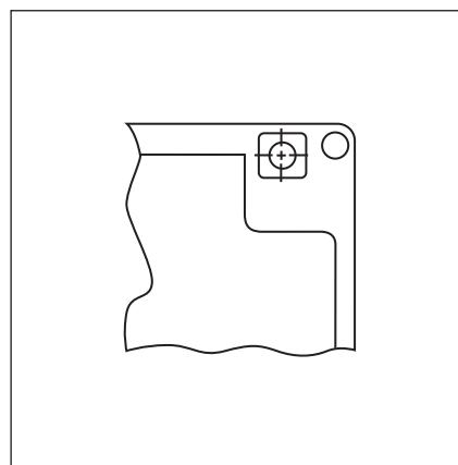
Рис. 3–12: Используйте отверстия крепления в корпусе
