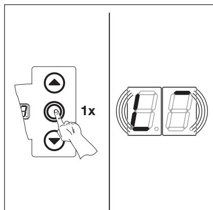
Рис. 6-15: Подтвердить индикацию вида монтажа, на дисплее появится индикация положения L.
