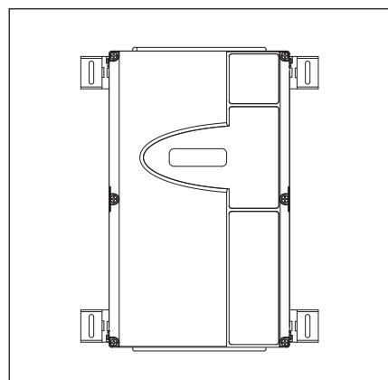
Рис. 3-8: Корпус блока управления с горизонтально закрепленными монтажными опорами
