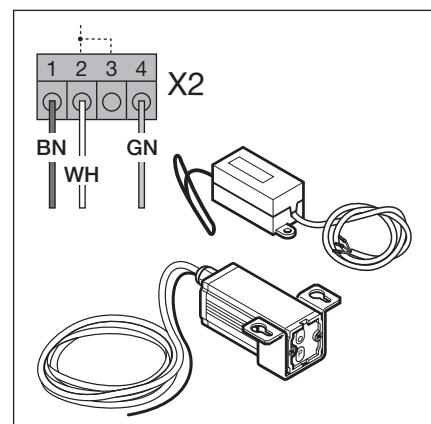
Рис. 4-25: Подключение приемника системы дистанционного управления
