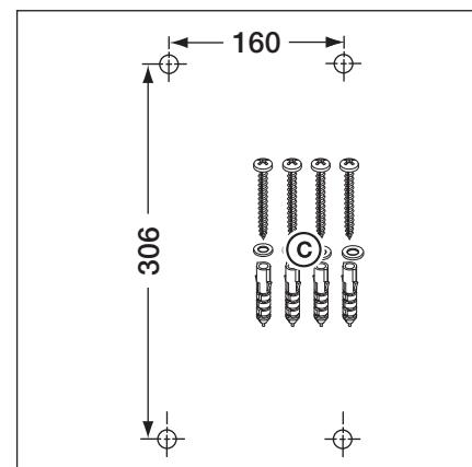
Рис. 3–13: Схема расположения отверстий для крепления, необходимые детали для монтажа
