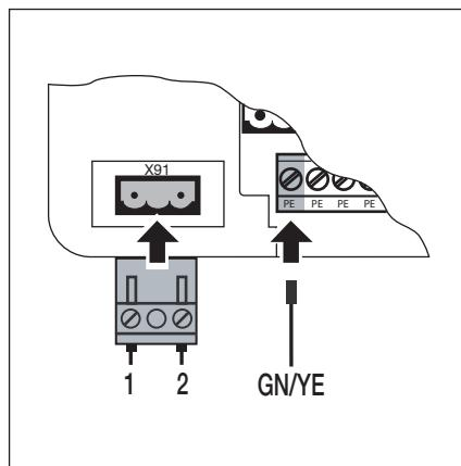
Рис. 4–16: Подключение провода электродвигателя к X91
