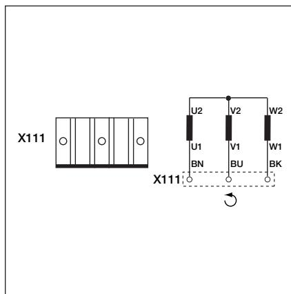
Рис. 9–2: Подключение обмотки электродвигателя
